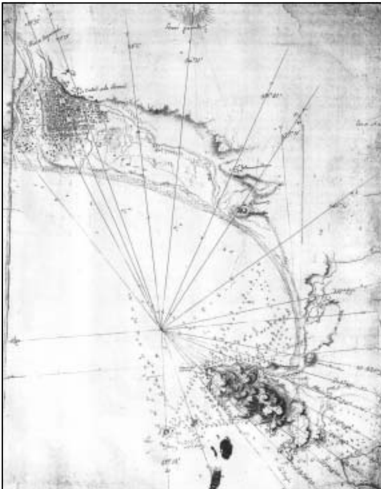
FIGURA Nº 5 BORRADOR DEL PLANO DEL PUERTO DE COQUIMBO. A PARTIR DEL CENTRO DEL PLANO SE TRAZAN DIRECCIONES (AZIMUT) HACIA ALGUNOS PUNTOS SITUADOS EN EL CONTINENTE
